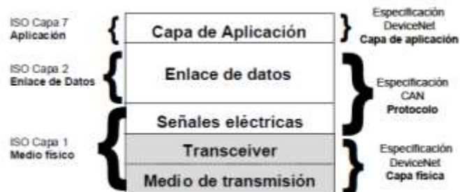
Figura 5. Ubicación de las capas ISO/OSI de DeviceNet y empleo del protocolo CAN en DeviceNet
